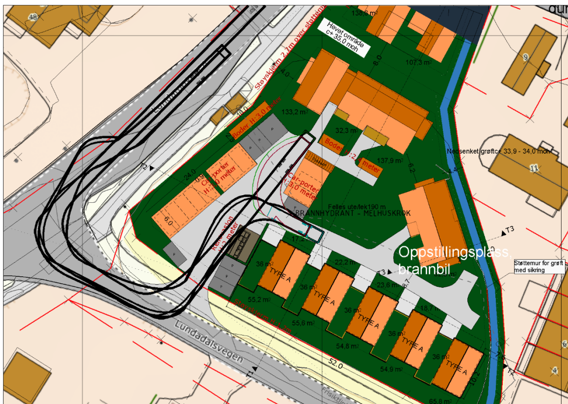
Figur 33 Sporingskurver og oppstillingsplass ved brannhydrant.
